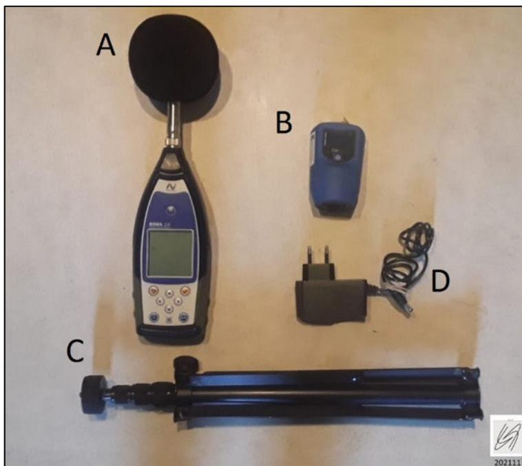
Figura 03: Equipamentos utilizados para amostragem do ruído predominante ao longo do traçado planejado do BRT-ABC: (A) Decibelímetro BSWA - modelo 308S; (B) Calibrador de nível sonoro (Classe 1) Inlite – modelo CalPro; (C) Tripé; (D) Fonte.
