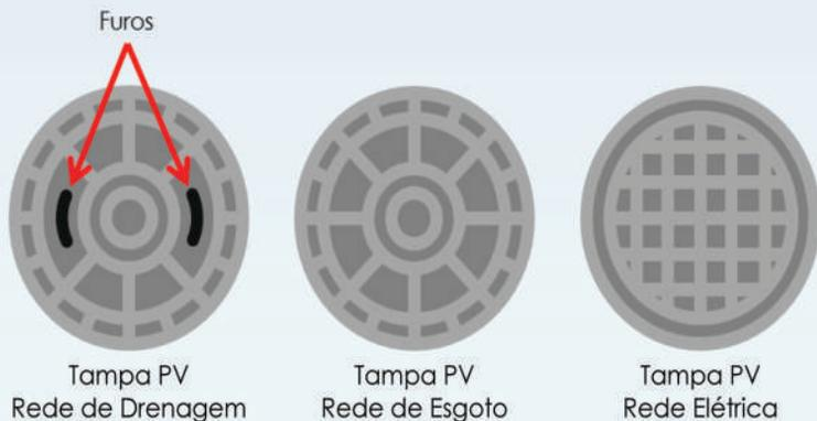
O poço de visita da Rede Elétrica tem uma tampa redonda e toda quadriculada. A Rede de Drenagem possui dois poços que servem diferentes funções: o primeiro tem furos na tampa e geralmente está escrito "águas pluviais", ligando-se à rede de drenagem de águas da chuva; o segundo não possui furos na tampa devido aos gases dos esgotos, e está ligado à rede de drenagem das águas servidas, o esgoto.
