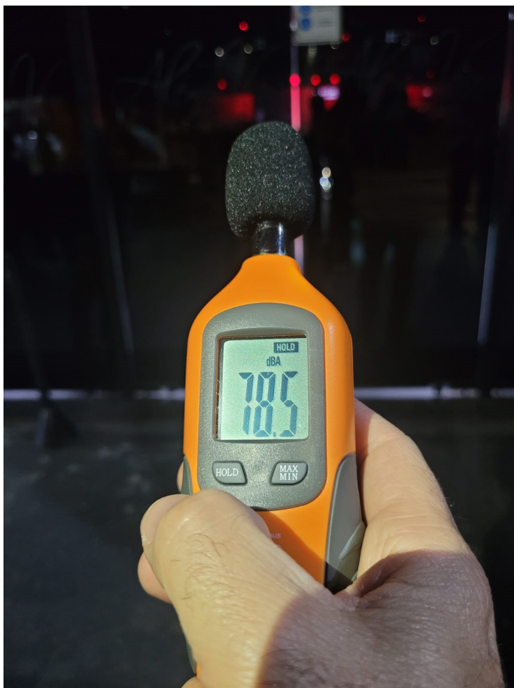
Figura 18: Aferição externa com a banda. 5mt da porta – 20:30hr
