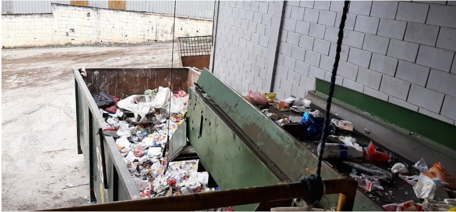
Figura 85: Rejeito ao final da esteira sendo conduzido para o contêiner.
