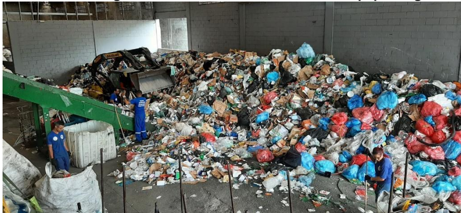
Figura 82: Área de descarga - Bobcat alimentando a esteira e equipe rasgando os sacos.
