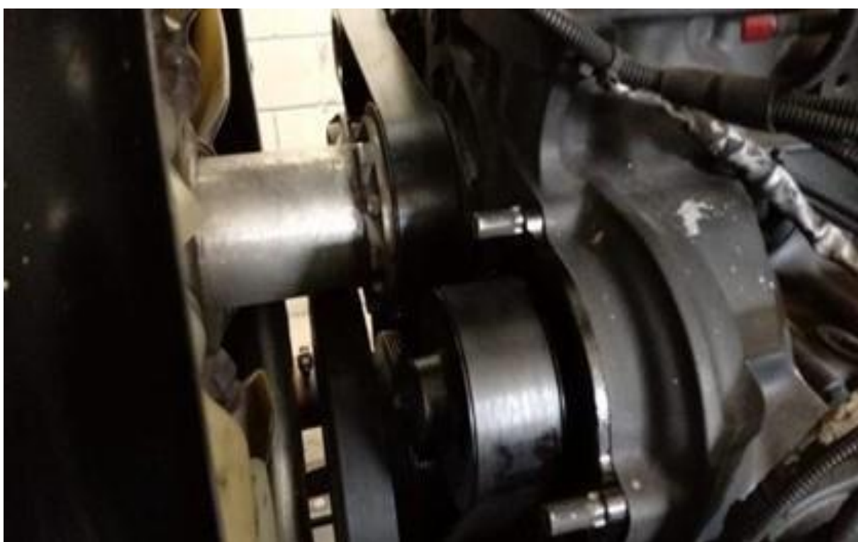
E.E. Vila Vivaldi - Serviço de manutenção corretiva nos componentes como bomba de água e troca das correias dentadas
