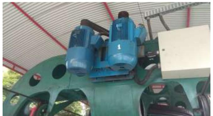
Motor principal, motor reserva e caixa seletora do motor
